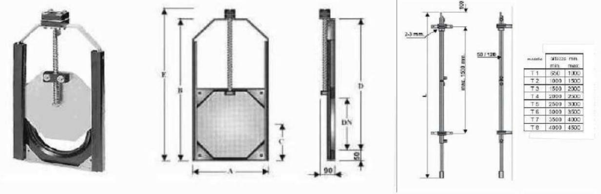
Paratoia murale a ghigliottina con tenuta in un senso di flusso per utilizzo in acque di superficie, scarichi e ambienti aggressivi; carico idraulico 1m; applicazione su parete verticale; pannello posteriore in PEAD; telaio a ghigliottina in acciaio inox AISI 316L; guarnizione di tenuta in EPDM; azionamento con vite non saliente in acciaio inox AISI 316L con filetto trapezoidale, passo 6mm, chiusura in senso orario
